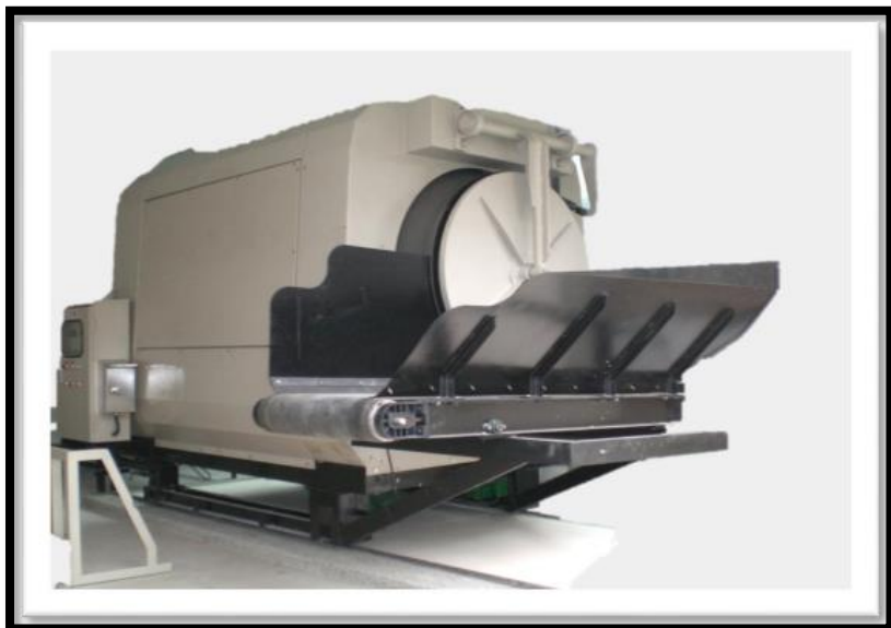
垃圾房內設的固定壓縮機 Fixed compactor in refuse room
